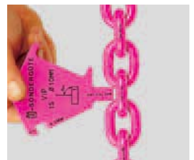
Prüfen Teilungs-Verlängerung durch Nenndicken-Verschleiß
