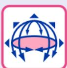
Anschlagpunkt ist in allen möglichen Richtungen belastbar.
