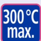
Maximale Einsatztemperatur des Anschlagpunktes mit prozentualer, produktabhängiger Tragfähigkeitsreduzierung.
