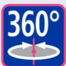
Anschlagpunkt besitzt die Fähigkeit sich 360° zu drehen. Jedoch nicht gleichzusetzen mit Drehen und Wenden unter Last!
