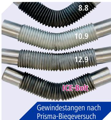
Gewindestangen nach Prisma-Biegeversuch
