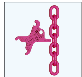
Comprobación del paso del eslabón provocado por el desgaste del diámetro nominal
