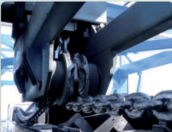
TECDOS Offshore Skidding-Systeme Antriebe für Verschubbahnen auf Pontons auf/unter Deck von Schiffen
