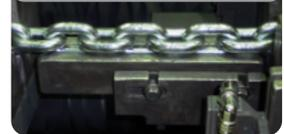
Die Kette wird auf das genaue Maß gebracht. Sowie Aufbringung der Fertigungsprüfkraft.
