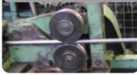
Die Vorziehmaschine zieht das Material auf den exakt benötigten Durchmesser.
