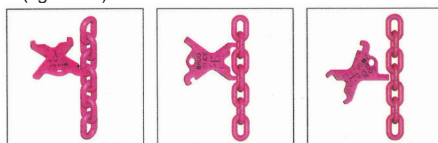
Fig. 33: Calibro catene ICE brevettato per rendere semplice controllo di c) e d)
