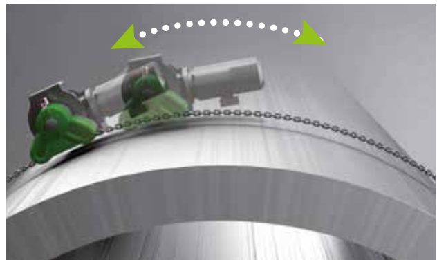
4. Rotative Bewegung, mobiler Antrieb und fixierte Kette/Geräte
