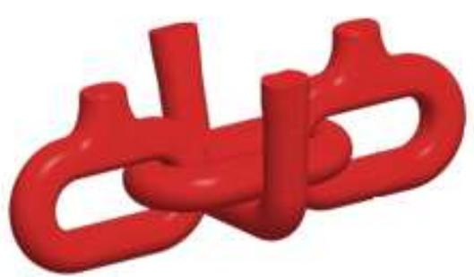
➤ Hier wird das stehende Kettenglied mit aufgeschweißtem Stachel durch ein adäquates Schmiedebauteil ersetzt. Daher keine Abscheren des aufgeschweißten Stachels möglich.
