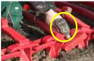
2. Bei beiden Hälften ist je eine Platte mit Schloss montiert – entfernen Sie 1 Platte (Ersatzplatte). Verbinden Sie beide Bandhälften mit einem kurzen Montageschloss (Schraubenmutter Innenseite Plattenband)
