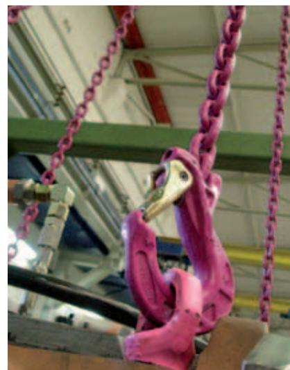
Bestehend aus geschmiedeter Sicherungsklappe, 3-fach gewickelter nichtrostender Doppelschenkelfeder und Sicherungsstift.
