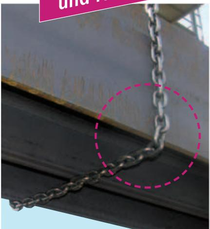
Ob heiß oder kalt, bei rauem Einsatz der ICE-Kette, insbesondere beim Umschlag von Formstahl wie Hafenumschlag oder Baubetrieb im Schnürgangeinsatz etc. bringt das patentierte Material und die spezielle RUD-ICE-Härtung Vorteile für den Anwender. Die Beschädigung der Kette durch Kantenumlenkung wird gegenüber einer Kette mit geringerer Festigkeit wesentlich reduziert.
