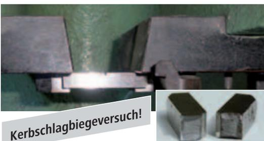
Durch Kerbschlagversuche wird nachgewiesen, ob die Kette unter besonders ungünstigen Bedingungen noch ausreichend Zähigkeit besitzt. Gegenüber einer Kette Güteklasse 8 = 40 J bei -20°C besitzt die RUD-ICE-Kette = > 55 J bei -60°C. Dies ist bei extremen Beanspruchungen besonders wichtig!
