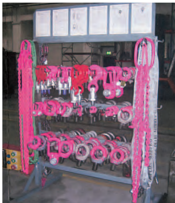
Almacenamiento correcto de cáncamos y eslingas de cadena BRG 500
