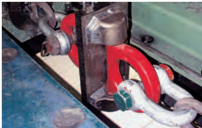
Control de producción en RUD Ensayo de rotura de un RBS de 50t de RUD, con una carga mínima de rotura de 2000 kN.
