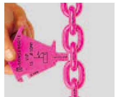
Controllo allungamento della dimensione nominale del passo per usura
