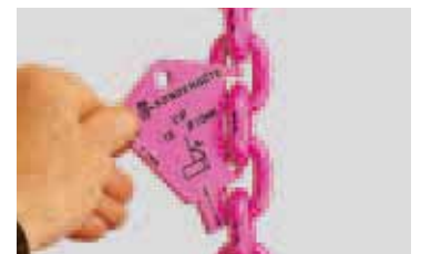
Test per allungamento del passo causato da sovraccarico.
