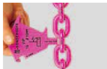
Test per allungamento causato da usura del diametro nominale.
