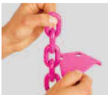
Controllo usura sezione Ø del diametro
