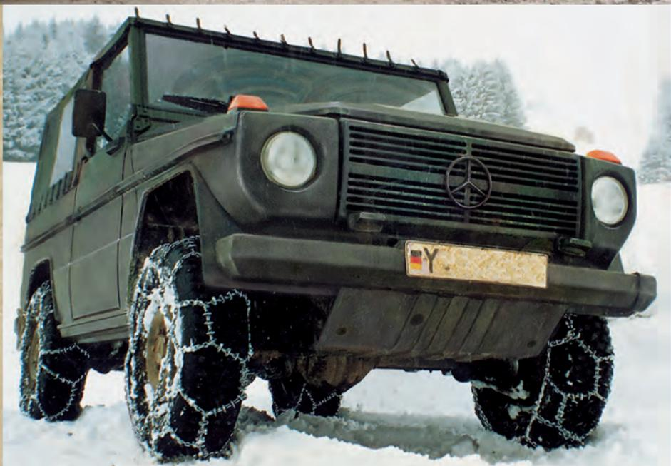
Speziell für den harten militärischen Einsatz entwickelte Gleitschutzketten garantieren höchste Traktion auf Schnee, Eis und im schwersten Gelände und somit höchste Mobilität.
