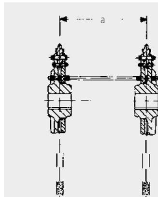
Abstand „a“ mittels 2 Distanzschrauben bei Montage distanzieren! (Entspr. Bohrungen an den Rädern vorhanden, Distanzschrauben keine RUD-Lieferung).
