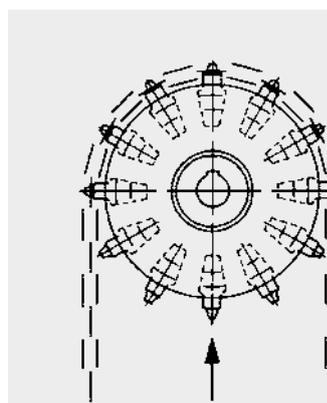
Bei Ersatzbestückung: Hier Einzelzähne ohne Ablegen der Kette auswechseln.
