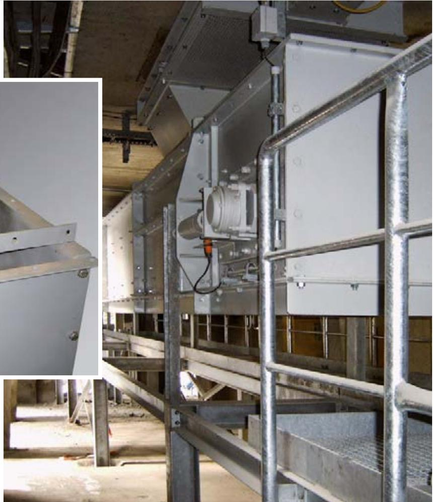
Die Spannstation hat Flanschlager zur Aufnahme der Spannweite. Die Wellendurchtrittstellen am Gehäuse werden mit nachschmierbaren doppelten Radialwellendichtungen ausgerüstet. Die gesamte Station mit Schauklappe ist komplett demontierbar und somit wartungsfreundlich. Die Vorspannung der Kette wird über gefederte Druckspindeln erzeugt und eingestellt.
