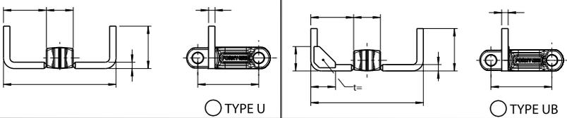
Type U und UB (UB Sonderanfertigung) für stark steigenden Transport, 10° bis 25°
