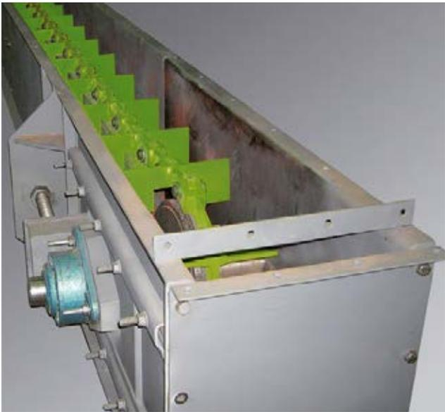
Die Antriebsstation hat je nach Baugröße Flansch- bzw. Stehlager zur Aufnahme der Antriebswelle. Zur Abdichtung dienen nachschmierbare doppelte Radialwellendichtringe. Die gesamte Station mit Schauklappe ist komplett demontierbar und somit wartungsfreundlich. Der Antrieb besteht aus einem Getriebemotor oder einer Getriebe-Normmotor-Einheit auf seitlich angeordneter Konsole. Zur Vermeidung von Überlasten können entsprechende Sicherheitskupplungen vorgesehen werden.
