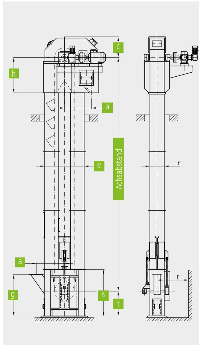
Die Ketten sind gehärtete Spezialentwicklungen aus legiertem Sonderstahl in hochverschleißfester Ausführung. Es kommen auch Laschenkettensysteme als Doppel- oder Zentralkette zum Einsatz.
