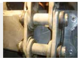
**Zentralkettenbecherwerke** für große Förderleistungen, grobe trockene Schüttgüter (Klinker, Schotter, Umlaufgut und Zementgrieße) und hohe Geschwindigkeiten (bis 1,7 m/s); Rundstahlkettenbecherwerke.
