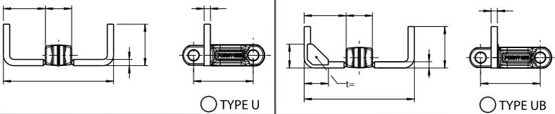
Type U und UB (UB Sonderanfertigung) für stark steigenden Transport, 10° bis 25°
