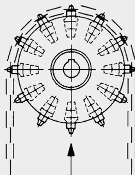
Bei Ersatzbestückung: Hier Einzelzähne ohne Ablegen der Kette auswechseln.
