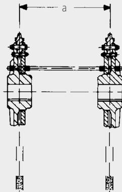
Abstand „a“ mittels 2 Distanzschrauben bei Montage distanzieren! (Entspr. Bohrungen an den Rädern vorhanden, Distanzschrauben keine RUD-Lieferung).
