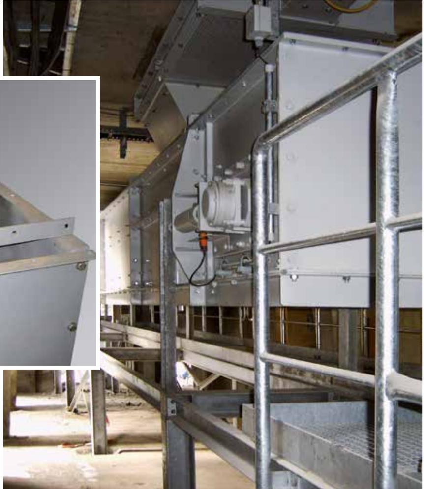
Die Antriebsstation hat je nach Baugröße Flansch- bzw. Stehlager zur Aufnahme der Antriebswelle. Zur Abdichtung dienen nachschmierbare doppelte Radialwellendichtringe. Die gesamte Station mit Schauklappe ist komplett demontierbar und somit wartungsfreundlich. Der Antrieb besteht aus einem Getriebemotor oder einer Getriebe-Normmotor-Einheit auf seitlich angeordneter Konsole. Zur Vermeidung von Überlasten können entsprechende Sicherheitskupplungen vorgesehen werden.
