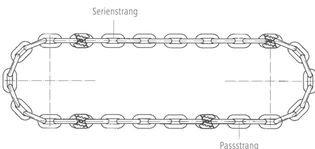
Bei Bestellung der Kettenschlaufe in Millimeter benötigen wir zur Aufteilung in die einzelnen Stranglängen den genauen Kratzerabstand.
