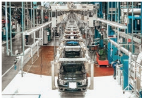
TECDOS Handling Verspannter, pendelfreier Hub von Bauteilen
