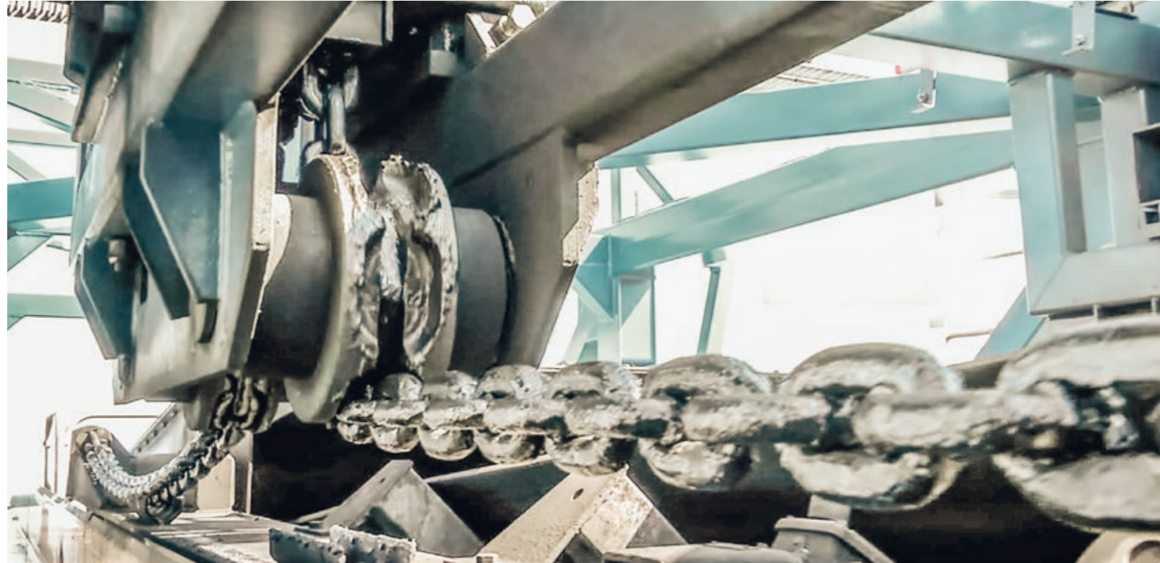
TECDOS Offshore Skidding-Systeme – Antriebe für Verschubbahnen auf Pontons auf/unter Deck von Schiffen
