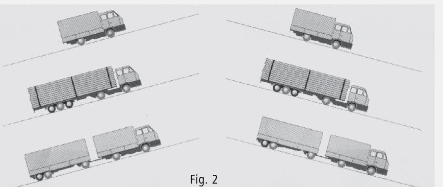
**Figure 1:** Sur un camion, les roues de l'essieu moteur devront toujours être équipées de chaînes. Sur les véhicules tracteurs ou les semi-remorques, les roues de l'avant-dernier essieu devront aussi être équipées. En cas de conduite en pente (montées/descentes), équiper en outre les essieux comme représenté en **fig. 2**.
