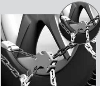
Acum mai trebuie prinse doar cele două ochiuri de trecere (9) prin cârligele din material plastic ale sistemului de întindere din guma. Vă rugăm să fiți atenți, ca plasa de lanț să fie așezată pe aceeași suprafață, pe flancul exterior al cauciucului. Modelul **easy2go** se tensionează automat în timpul mersului.
