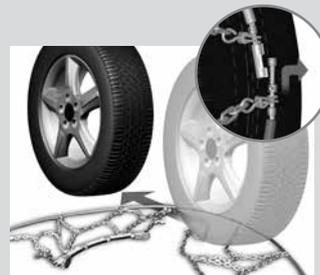
Dacă lanțul antiderapant nu se mișcă înspre exterior, va ușura demontarea o smucitură ușoară. Acum puteți așeza lanțul pe pământ și demonta și celălalt lanț de pe partea cealaltă a mașinii dvs. Rulați apoi afară din lanțul antiderapant!
